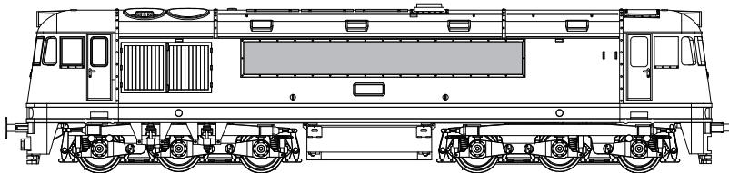
**Parametry modelu:** délka přes nárazníky: 209mm, hmotnost: 615g, napájení: 12VDC, odběr motoru 0.3A max, min. poloměr oblouku: 360mm
